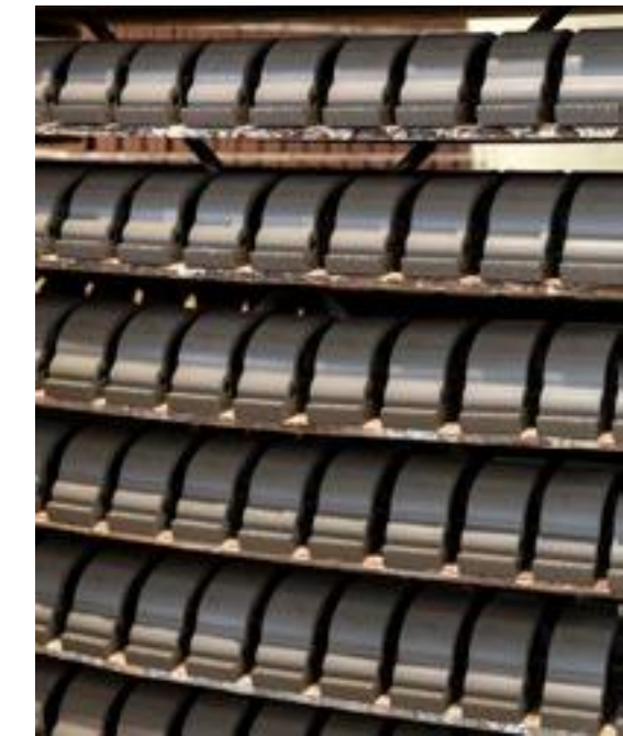
1. Extrusionado de la arcilla y el corte 2. Secado de las piezas 3. Horneado a una temperatura a más de 1020° 4. Pieza final 1. Extruding the clay and cut 2. Drying the parts 3. Baked at a temperature over 1020° 4. Final piece
